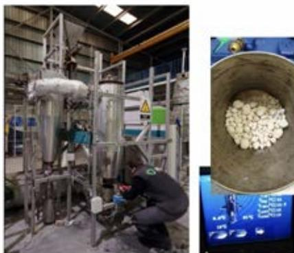
Figura 1. Concepto HECO® aplicado a la Carbonatación Acelerada (CCA) de residuos alcalinos
