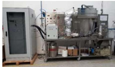
**Figura 3.** Planta piloto de metanación de lecho fijo
