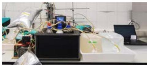
**Figura 2.** Módulo de síntesis electroquímica microbiana para producir CH<sub>4</sub>.
