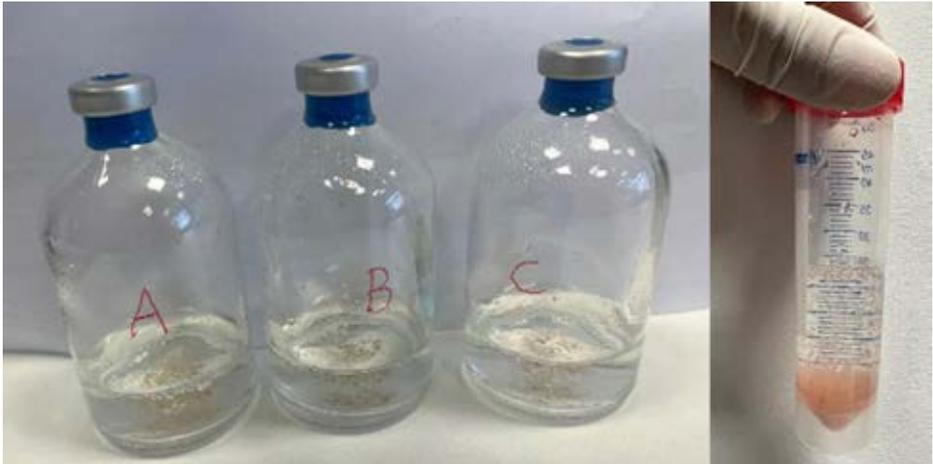
**Figura 1.** 3 lotes: T: 25 °C, 180 rpm, Vt=120 mL, Fuente de C: ~20% CH<sub>4</sub> (~80% aire), Medio mineral: macro y micronutrientes [1] (izda.); cultivo mixto enriquecido (dcha.)
